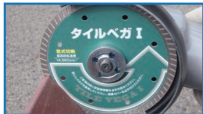
タイル・瓦の切断
